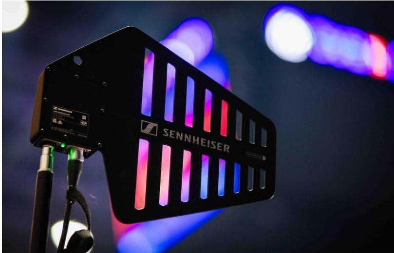
Die DAD-Sende- und Empfangsantenne des Spectera-Ecosystems trägt alle erforderlichen HF-Komponenten und macht Booster, Splitter und Combiner überflüssig
